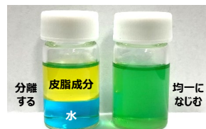
図4. 皮脂成分と水の混和実験
