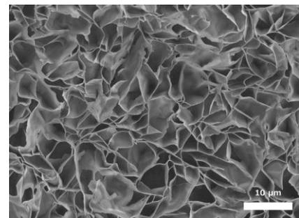
図2 口紅の従来の電子顕微鏡像
