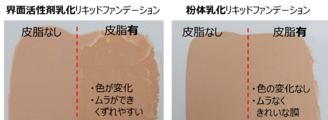
図4. リキッドファンデーションを塗布した時のくすみ比較 人工皮脂を塗った板にリキッドファンデーションを塗り、皮脂の有無による差を観察
