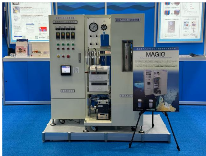
図 3. 株式会社 AKICO と共同開発した流通型の MAGIQ 乳化装置。高温高压下で油と水を混合し、急冷することでナノ乳化を実現。深海熱水環境の温度変化を模倣した装置構成が特徴。
